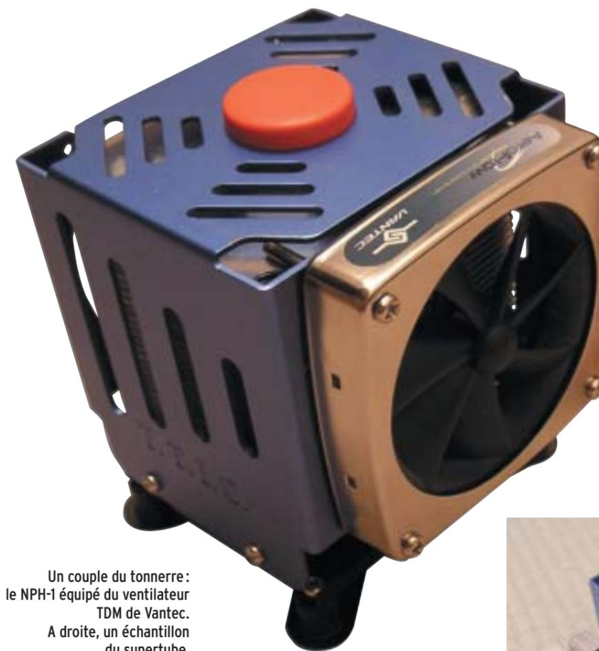
Un couple du tonnerre : le NPH-1 équipé du ventilateur TDM de Vantec. A droite, un échantillon du supertube.
